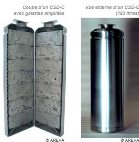
Figure 4 : Conteneurs de déchets compactés (CSD-C) (Source : dossier)
