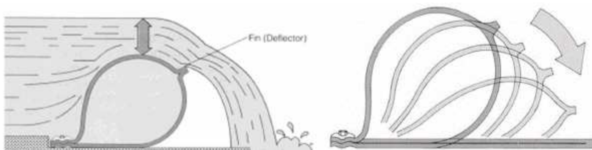
Figure 4: principe de fonctionnement d'une bouchure gonflable (source : étude d'impact)
